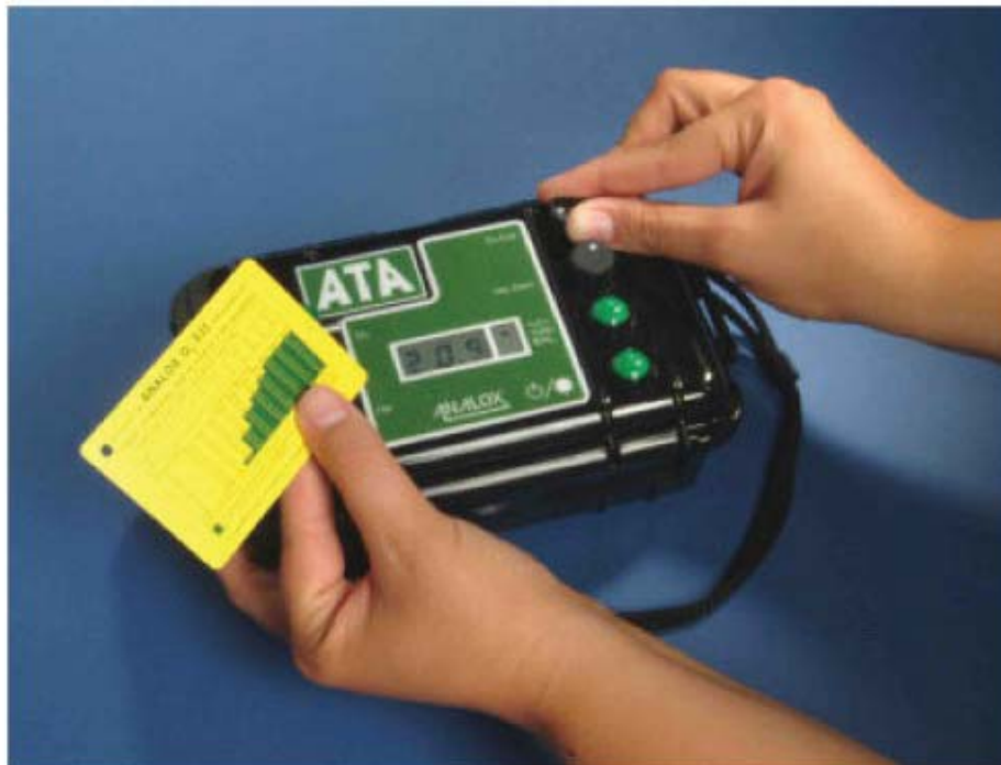
Кислородная калибровка на чистом воздухе
