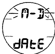
Рис. 7 - УСТАНОВКА ФОРМАТА ДАТЫ
