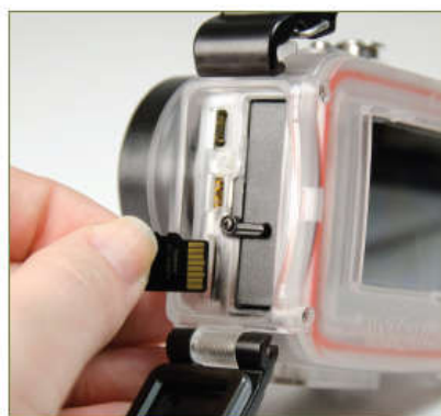
4. Установите карту памяти (Micro SD объемом до 32 GB, рекомендуется класс скорости 10)
