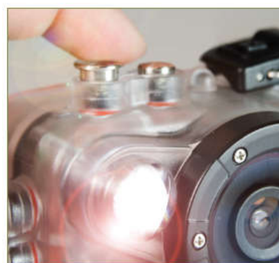
7. Нажмите и удерживайте кнопку спуска для включения подсветки
