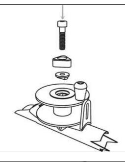
Установите катушку, шайбу, зажим и соединяющий винт в порядке, показанном на схеме
