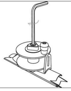
Затяните винт с помощью 6 мм универсального гаечного ключа
