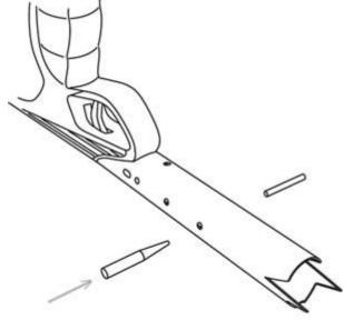
Извлеките штифт с помощью заостренного съемника, для того чтобы установить держатель катушки
