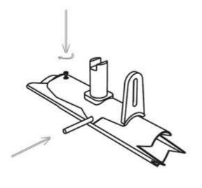
Вставьте держатель катушки, штифт (33,35 мм) и винт, как показано на схеме
