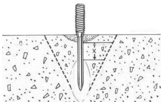
Для достижения правильной взаимосвязи между областью X и связью в овале основное правило заключается в следующем: Убедитесь, что заглубление стержня дюбеля в бетон приблизительно в 8 раз больше диаметра самого стержня. У твердого бетона - высокая удерживающая способность, у мягкого бетона - меньше. Более мягкая рабочая поверхность требует большей длины стержня дюбеля, чем твердая для максимальной удерживающей способности.
