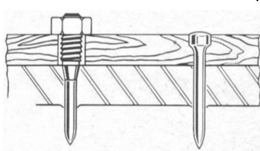
Для выбора подходящего дюбеля необходимо толщину материала, который будет закреплен ( $X$ ), прибавить к толщине стали плюс 12 мм (для подстраховки) ( $Y$ ), равняется общей длине стержня.
