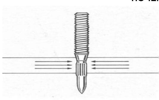
Удерживающая способность в стали зависит от её эластичности. Сталь сдавливает стержень дюбеля. Стержень дюбеля должен пробить сталь насквозь. В противном случае сталь, сжимаясь, будет оказывать пружинное давление на острие стержня дюбеля, вытесняя его. Удерживающая способность в стали зависит также от её толщины и диаметра стержня дюбеля.
