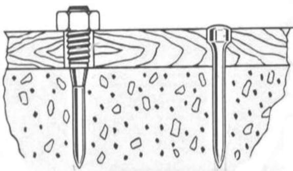
На рисунке слева резьбовая шпилька и дюбель прикрепляют доску к бетону.
