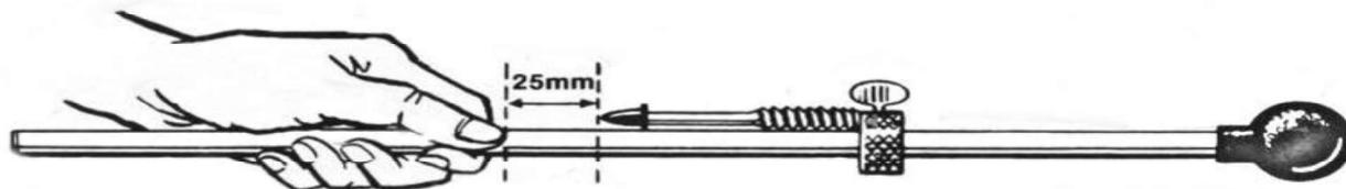
2. Далее, от зафиксированной шайбы, отмеряем длину дюбеля и прибавляем к ней 25 мм. Ослабляем винтовой зажим и перемещаем подвижную шайбу к отмеренной точке. Фиксируем шайбу винтовым зажимом. **Проверьте надежность фиксации шайбы и невозможности её смещения!**
