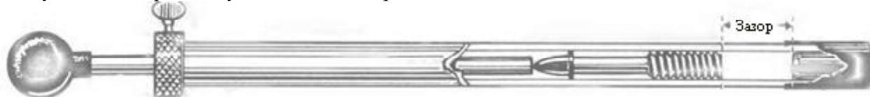
Для снижения мощности примерно на 10%, достаточно сделать приблизительно 17-миллиметровый зазор, на 15% - 25-миллиметровый зазор, на 20% - 33-миллиметровый зазор и т.д.
