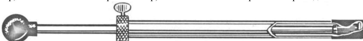
1. Для того, чтобы установить 25-миллиметровый воздушный зазор необходимо шомпол вставить в направитель до упора и зафиксировать в этом положении подвижную шайбу на шомполе, при помощи винтового зажима.
