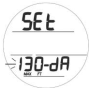
Рис. 47 Установка глубинного сигнала
