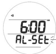
Рис. 17 Статус будильника (нет доступа к установке)
