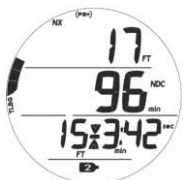
Рис. 79 Основной экран времени остановки безопасности (ON – установлены глубина/время)
