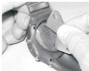
Рис. 132А Снятие крышки (используя инструмент)
