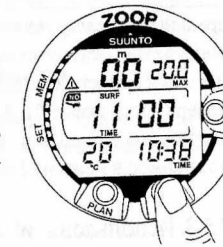
Рис. 3.28 Время нахождения на поверхности и время запрещения полетов. Дважды нажав на кнопку TIME, Вы увидите время запрещения полетов.
