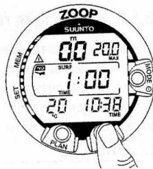
Рис. 3.27 Время нахождения на поверхности. При нажатии кнопки TIME будет отображаться данная информация.
