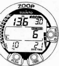
рис. 3.16 Декомпрессионное погружение, глубина меньше глубины «пола». Стрелка, направленная вверх, исчезла, а надпись ASC TIME мигает. Вы находитесь на глубине декомпрессии.
