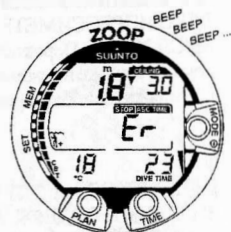
рис. 3.18 Декомпрессионное погружение, глубина меньше глубины «потолка». Обратите внимание на сигналы тревоги. Вы должны немедленно (в течение 3 минут) погрузиться ниже «потолка».
